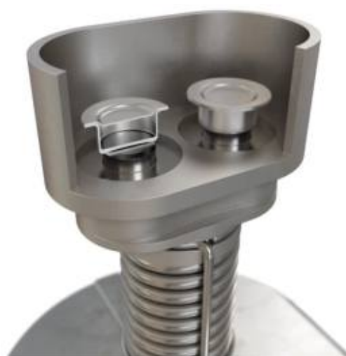
Figura 2. Horno de masa térmica muy pequeña (Arena®) y portamuestras.
